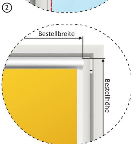
Die Rollokassette wird auf dem Fensterflügel verschraubt. Die seitlichen Führungsschienen werden verklebt. Eine gerade Anklebefläche von rundum **mindestens 10mm** muss vorhanden sein.
